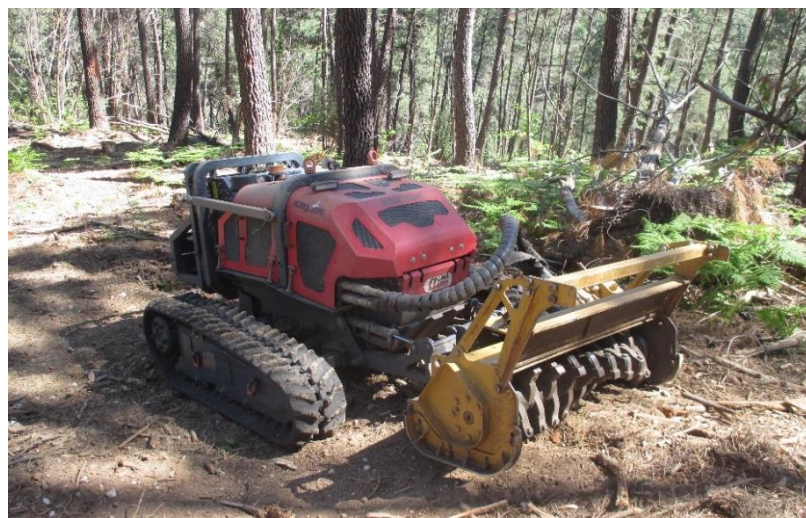
Figure 4 : Broyeur à marteaux intervenu sur 1ha dans le chantier d'éclaircie (A. de Montbron)
